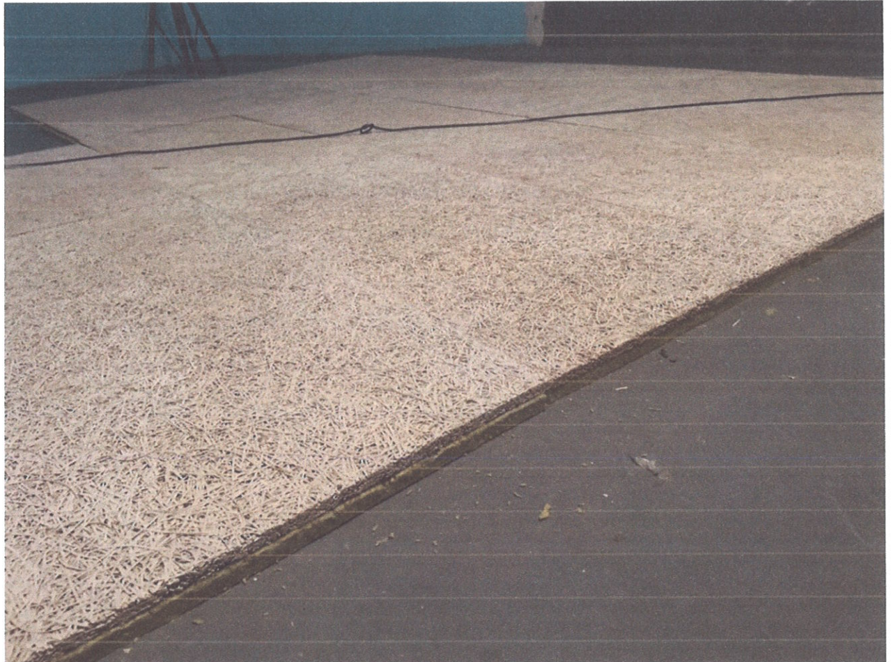
Рисунок 2 – вигляд випробуваної конструкції Kraft WoodAcoustic 15 мм+ Stalker Basalt Acoustics Floor 20 мм
